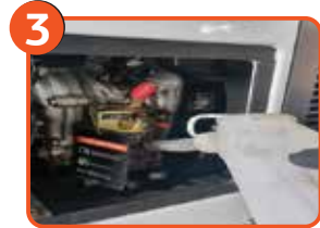
ПРОВЕРЕТЕ И/ИЛИ ДОЛЕЙТЕ МАСЛО НА ДВИГАТЕЛЯ
